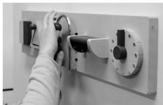
視覚障がい者がボールを動かして風量を設定している様子
