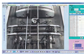
屋根上監視部画面
