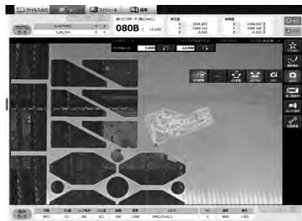
図2. MEL'S ARによる加工形状位置決め(変換画像)
