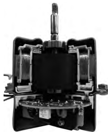
定風量制御機能付き換気扇用DCブラシレスモータ
