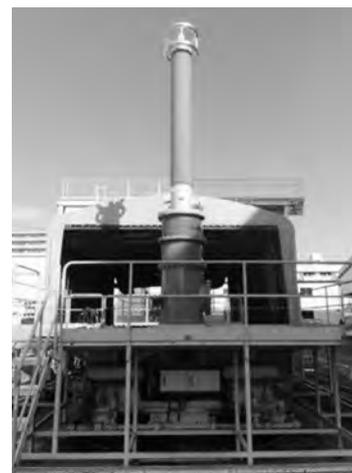
275kV変圧器用ポリマガスブッシングの耐震試験実施状況
