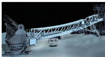
分割鏡交換システム(主鏡にかかる15mのブリッジとブリッジ下を走行する分割鏡交換ロボット)
