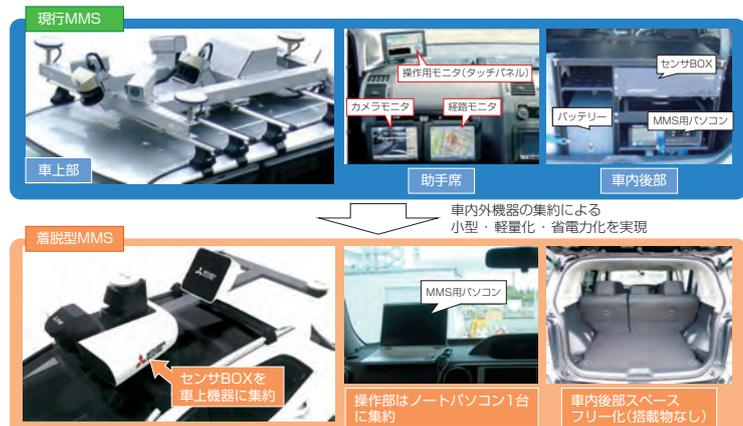
図2. 現行MMSと着脱型MMSの比較
