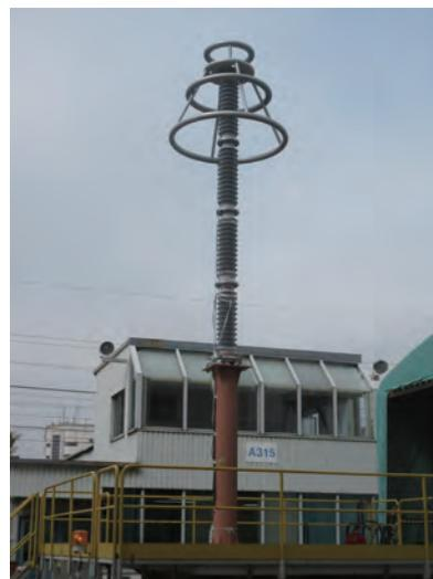
500kV系統用ポリマー形避雷器
