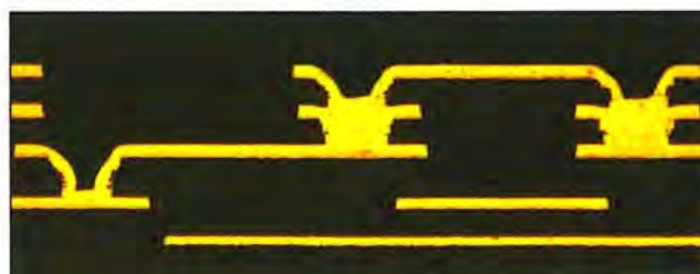
全層ガラスエポキシ超薄型構造
