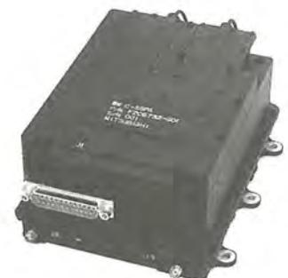
C帯 8W固体化電力増幅器外観
