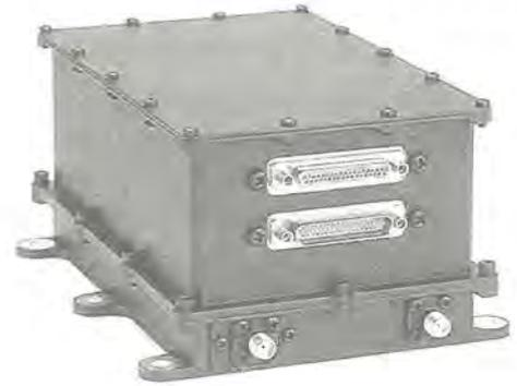
C帯固体化電力増幅器の外観
