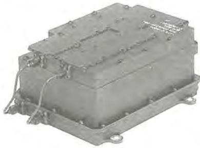
C帯17W固体化電力増幅器外観
