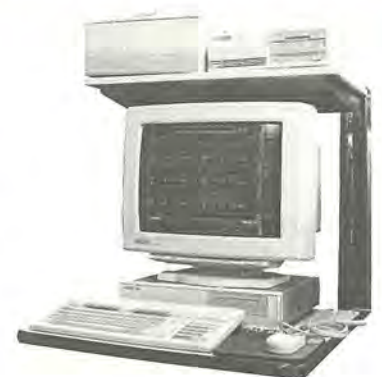
制御棒制御装置波形点検装置
