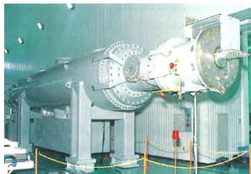
1,000kV GIS温度上昇試験状況
