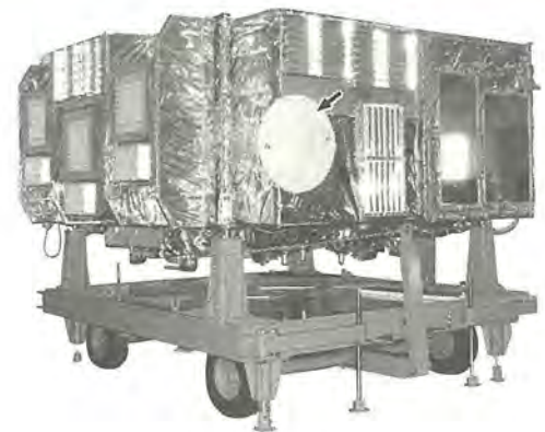
地球観測プラットフォーム技術衛星搭載直接伝送系
