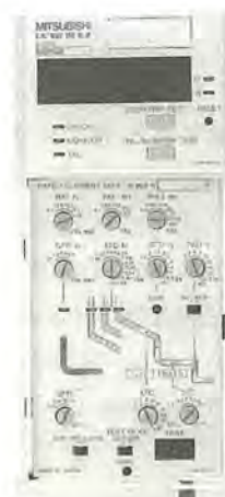
低圧気中遮断器搭載用 デジタルリレー
