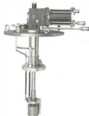
GM冷凍機による伝導冷却高温超電導マグネット
