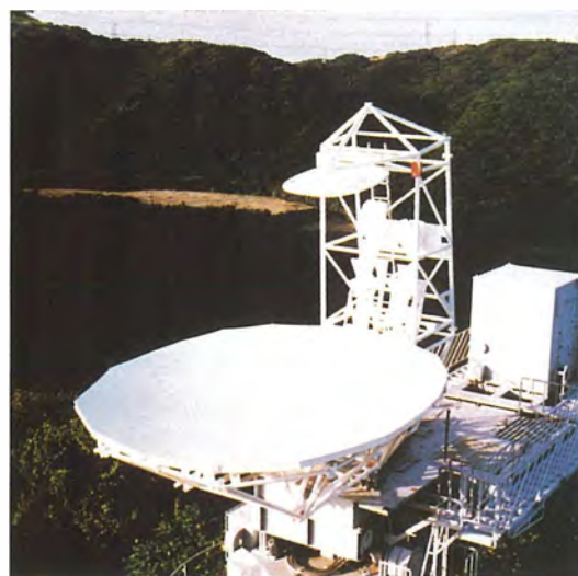
大型回転台で電気特性測定中のアンテナ (NTT提供)
