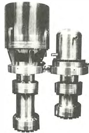
フリーピストン型ヴィルミエヒートポンプ試作機
