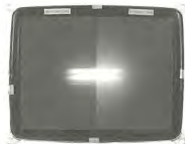
外光の映り込みの低減 (左半分：K-COATING、右半分：従来防眩処理 (E-COATING))
