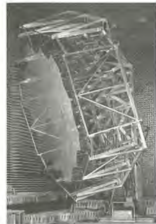
電気試験下の試作鏡面
