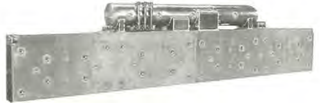
山梨実験線向け超電導磁石第1号機 (鉄道総研納入)
