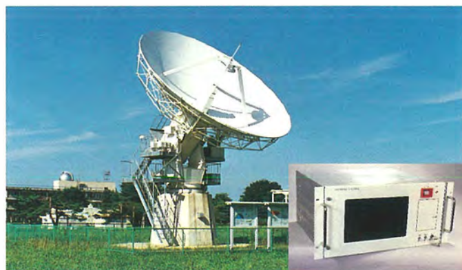
短波長高精度VLBI用アンテナとアンテナ制御装置
