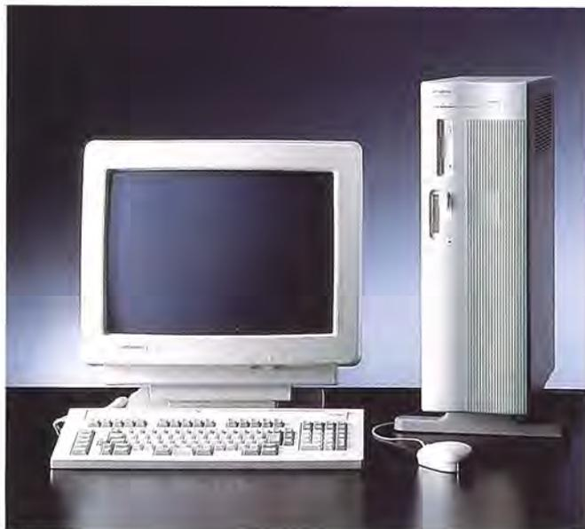
国際標準、業界標準を全面的に取り入れた三菱エンジニアリングワークステーションMEシリーズのラインアップに新しく〈ME550/550E/550F〉が加わりました。最新鋭のマイクロプロセッサMC68040 (25MHz) を搭載し性能向上を図るとともに、CPUボードは高密度実装技術により信頼性の向上を実現しました。さらにMEシリーズで培われた豊富な資産やユーザアプリケーションをそのまま継承できる上位互換性を確保した高性能EWSです。
