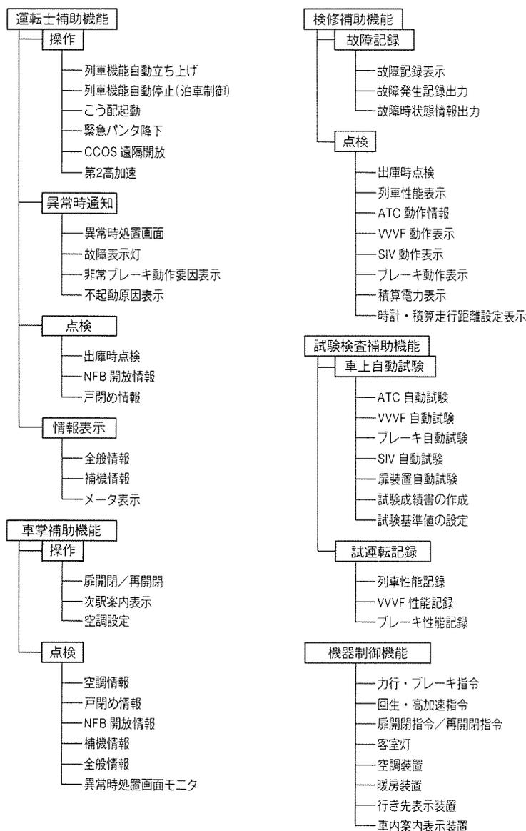
図14. 車上遠隔制御装置のシステム機能
