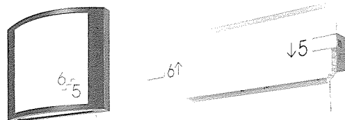
新形階段通路誘導灯
