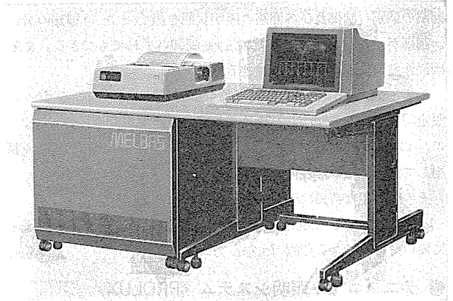
小規模ビル管理システム
