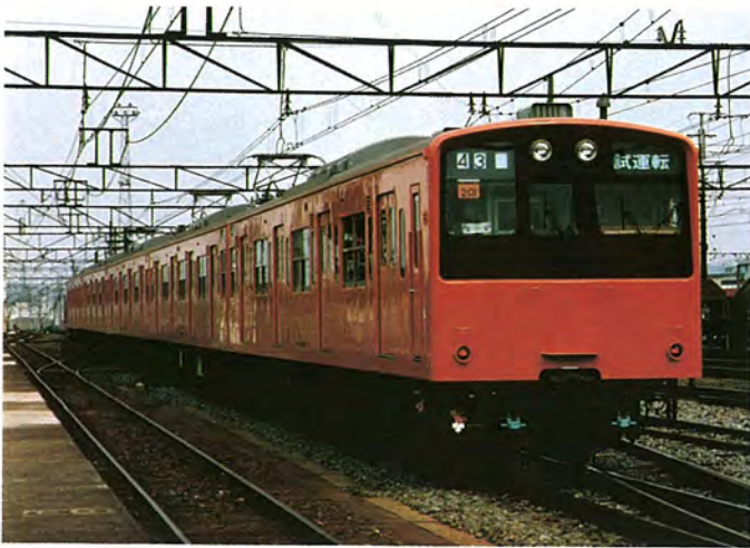
▲チョップパ制御方式の日本国有鉄道201系新通勤形電車(左)と大阪市交通局10系電車(右)
