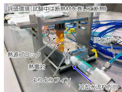
(c) よりよりフィン試作品を用いた冷却性能評価装置
