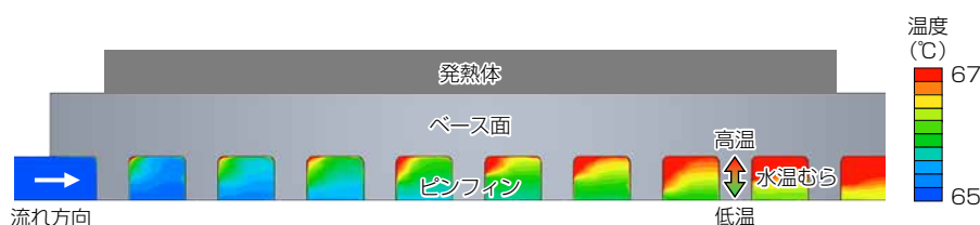
図2-ピンフィンでの水温むら発生時の解析温度コンターの例
