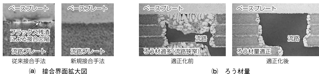
図6-新規接合手法による接合品質の改善とろう材量の適正化
