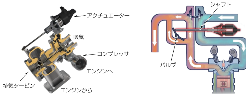
図1-ターボチャージャー用途での使用例
