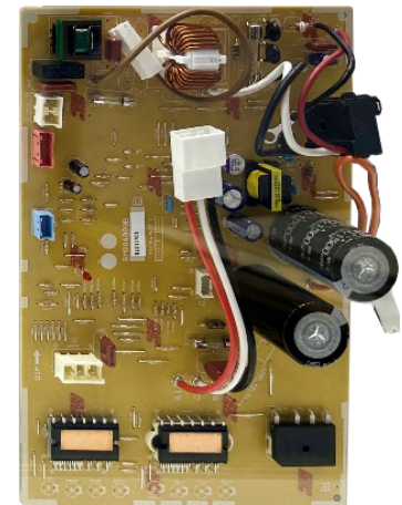
家庭用エアコン コンプレッサー駆動用基板
