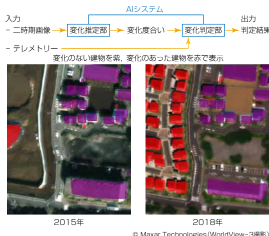
図2-AIシステムの概要と建物変化判定結果
