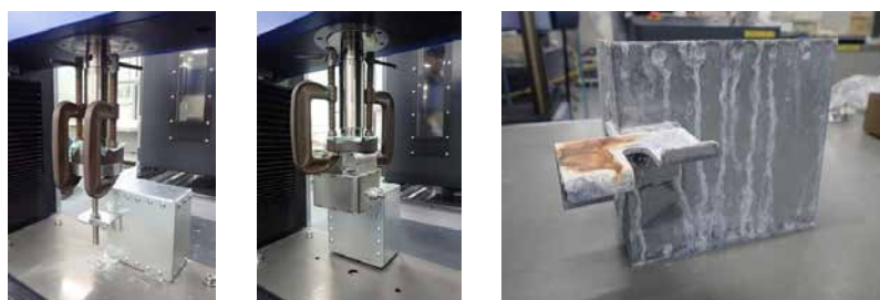
図5-加速試験の例（天吊り金具劣化後の強度確認試験）
