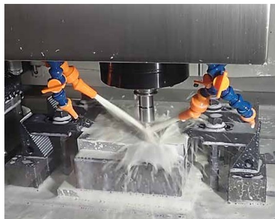
図7-製品模擬ワークのエンドミル加工
