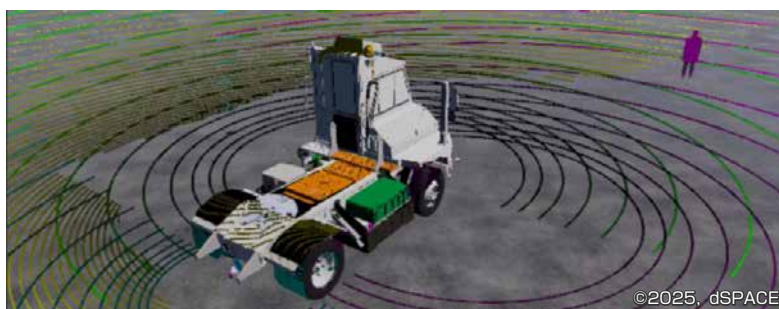
図2-トラクターの認知技術のシミュレーション動作例
