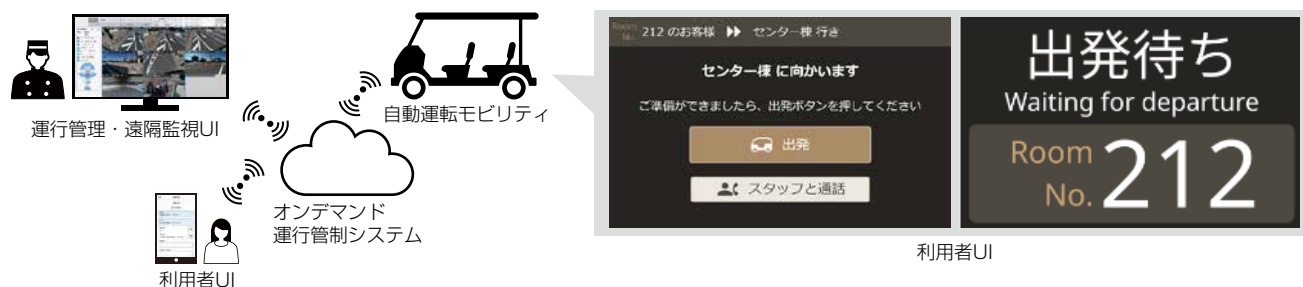
図2-リゾート施設向け自動運転モビリティ管制システムの構成図
