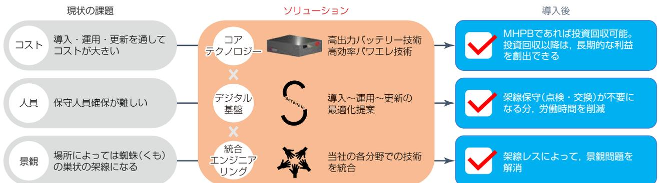
図5-架線レストラムでのバッテリー導入に対する当社のソリューション
