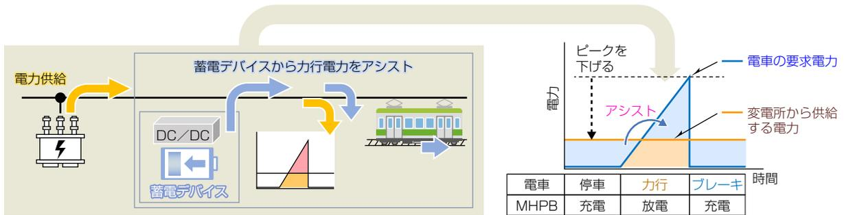
図6-鉄道のピークカットシステム
