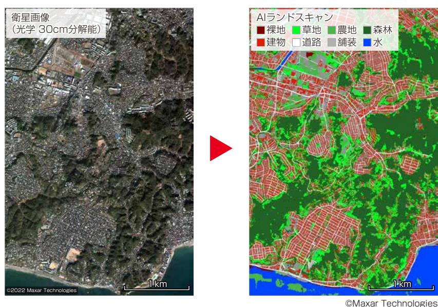
図3- 高分解能光学衛星(Worldview-3)から土地利用AIを実行した例
