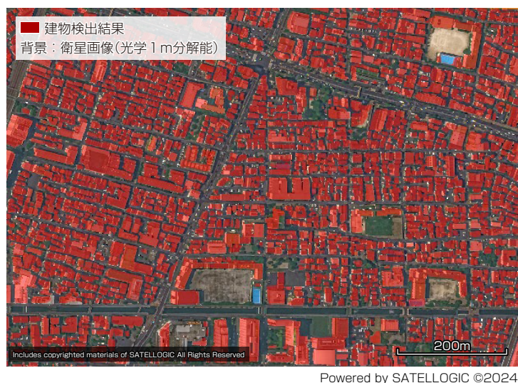
図5-Satellogic衛星画像から建物検出を実施した例
