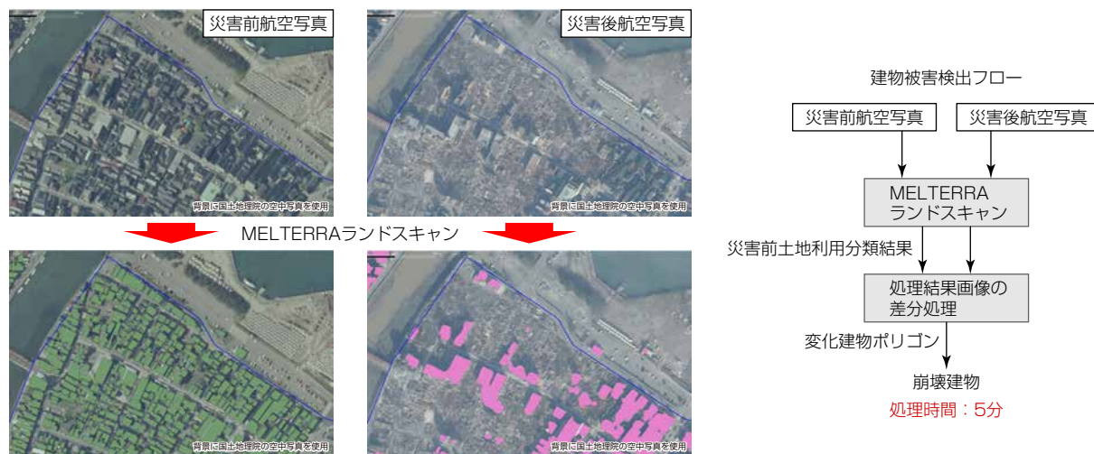
図13-建物単位の被害解析の例と解析フロー
