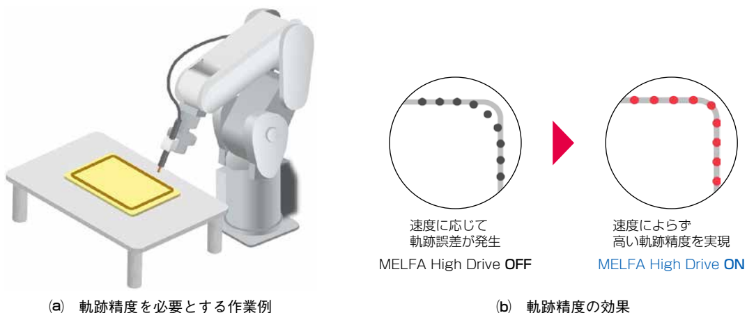
図3-MELFA High Driveの軌跡優先モード
