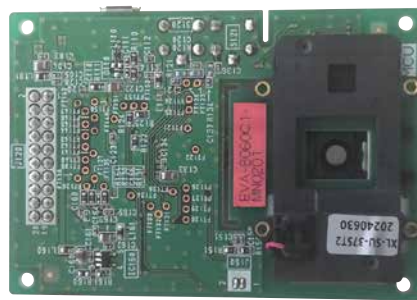
図9-評価用デモキット(78×54×13(mm))
