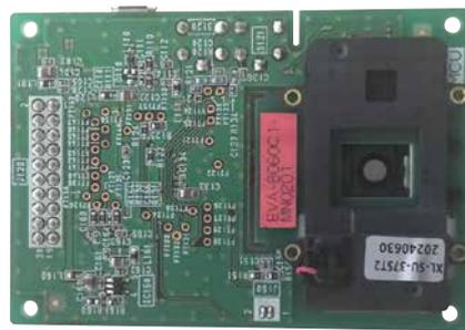
図9-評価用デモキット(78×54×13(mm))
