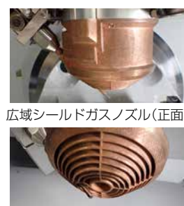
ノズル、チタン合金造形サンプル
