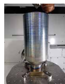
チタン合金造形サンプル (燃料タンクを模擬)
