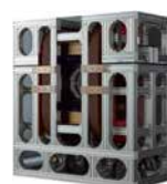
磁気粒子イメージング装置の試作機(左)、チューブに磁気粒子を注入したサンプル(中央)と撮像(右)
