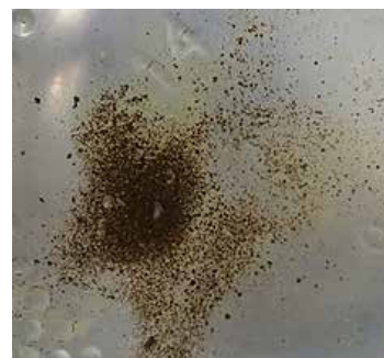
図1-室内暖房(ラジエーター)等から発生する鉄さび
