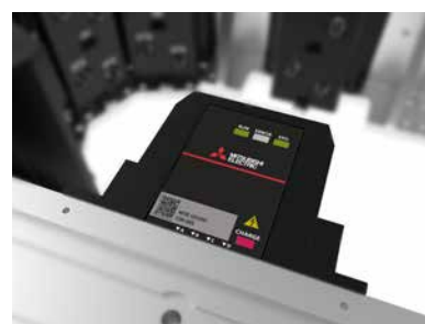
リニアトラックシステムの モータードライバー (機能表示部)
