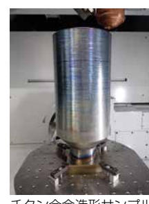
チタン合金造形サンプル (燃料タンクを模擬)
