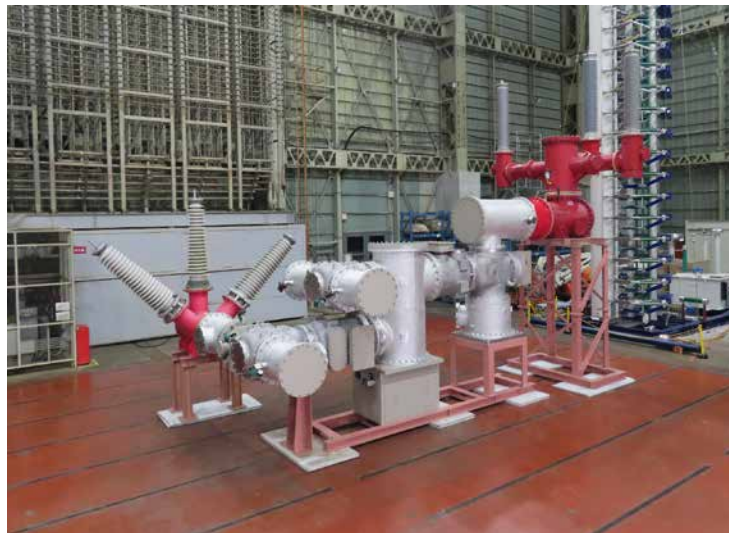
図6-耐電圧試験状況
