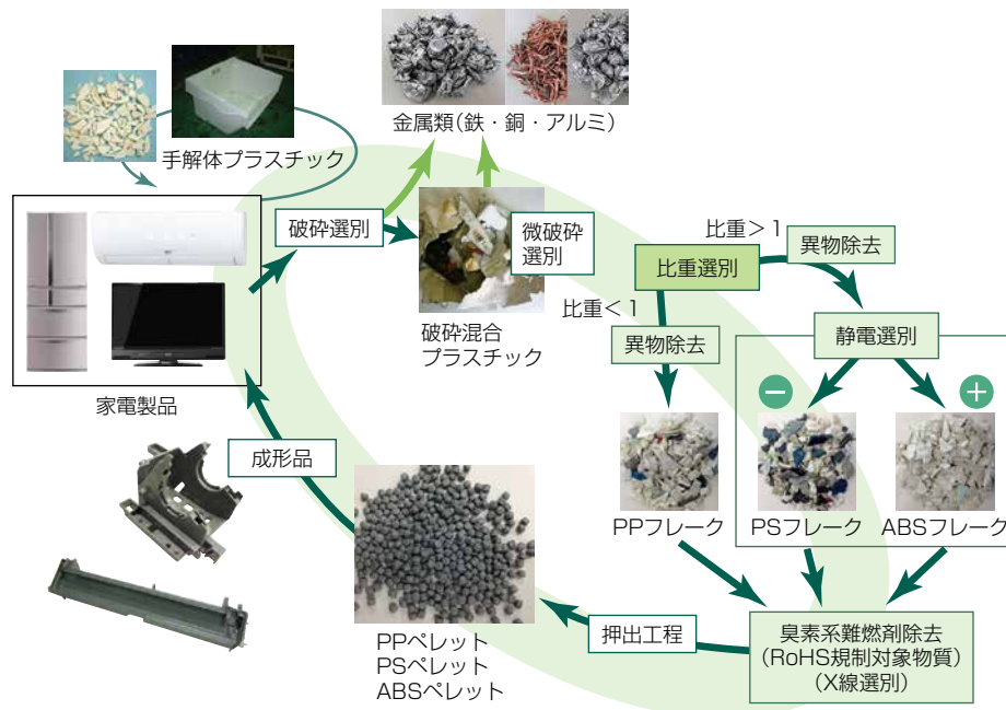
使用済みの家電製品を破碎して生じる破碎混合プラスチックは，比重選別，静電選別，X線選別などの選別過程を経て，プラスチックの種類ごとに高純度で回収され，再び家電製品に使用される。
