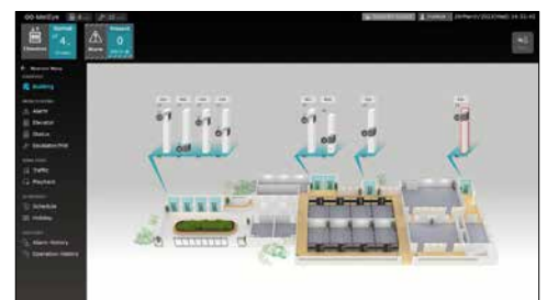
立面図とフロア図を組み合わせた監視画面
