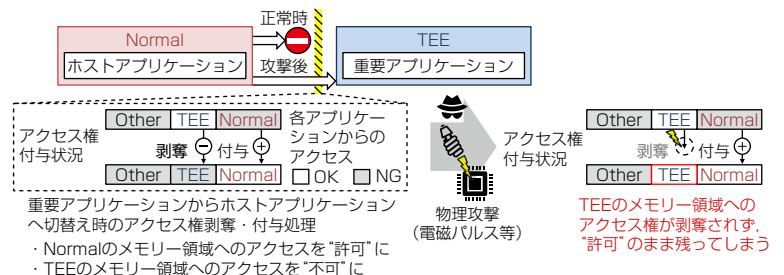
図1-アクセス権剥奪処理のスキップによるアクセス権を奪取する攻撃
