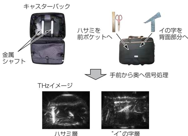
図1-金属検知を想定したテラヘルツ波測定結果
