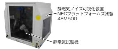
図1-静電気ノイズ可視化装置
