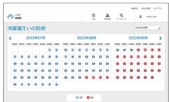
図3. 冷媒漏えいの診断結果画面
