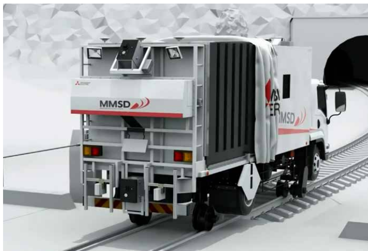
図8. 3D点群データを取得するためのMMSD車両
