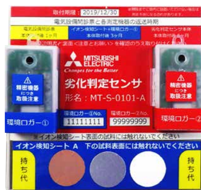
図6. 受配電機器の診断に使用する劣化判定センサ
