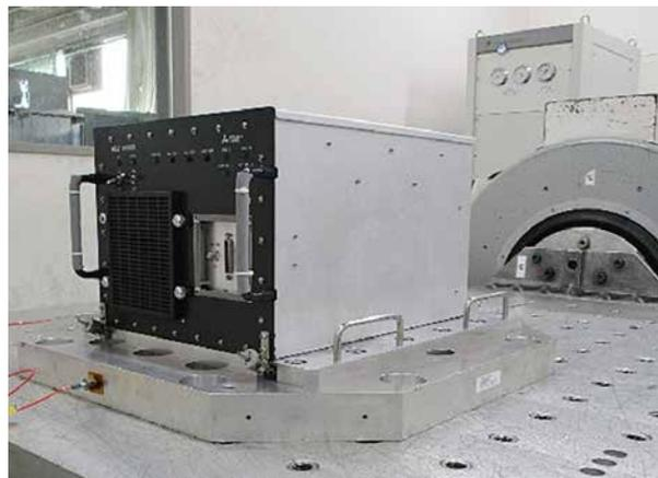
図9. IDUの振動試験
