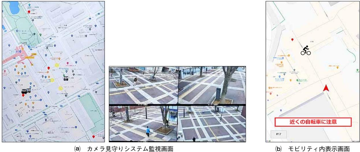
図9. カメラ見守りシステム監視画面とモビリティ内表示画面の例
