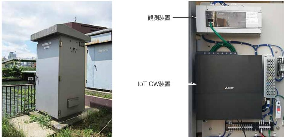
図4. 観測所(機器取付け例)
