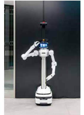
ビル設備と連携して ビル内を自律移動 する警備ロボット
