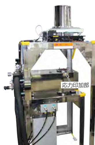
図1. 開発した磁気特性評価装置
