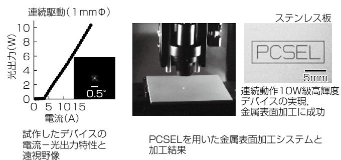
図2. PCSELの性能評価結果
