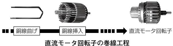
直流モータ回転子の巻線工程
