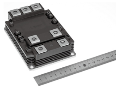
図5. LV100タイプのフルSiCパワーモジュール
