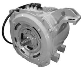
図3. 鉄道車両用SynRM
