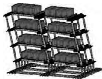
図11. 変換器の耐震解析結果(固有振動評価)
