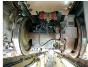
13000系に搭載されたSynRM (台車臓装(ぎそう)状態)
