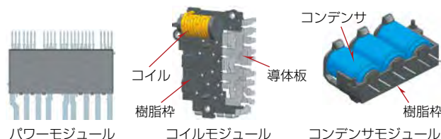
実装する部品のモジュール化
