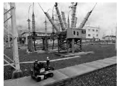
変電所での自律走行検証状況
