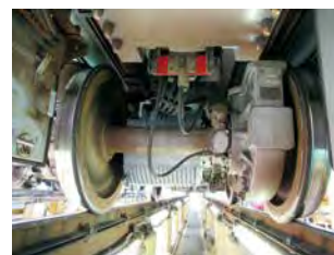
13000系に搭載されたSynRM (台車機装(ぎそう)状態)
