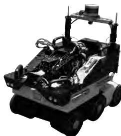
クローラ型巡視ロボット (開発プロト機)
