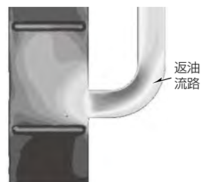
ガスヘッダ内部の冷媒流動解析
