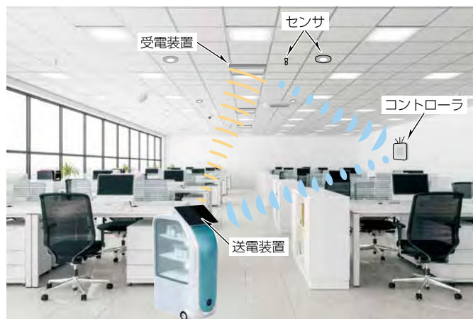
図1. オフィスでの空間伝送型無線送電システムの概念図
