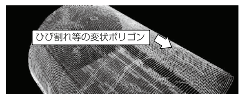
図9. 変状を含むトンネル覆工面の三次元モデルの生成の例
