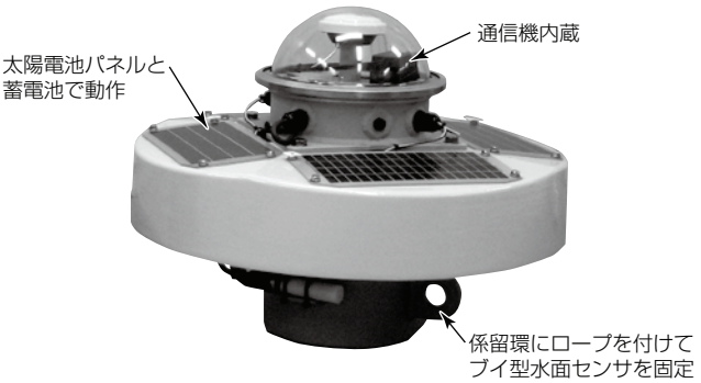
図3. ブイ型水面センサ
