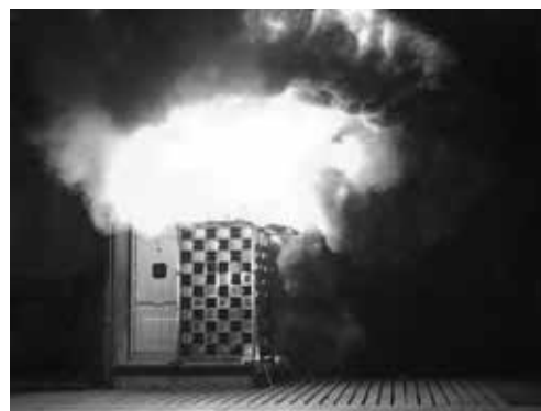
図1. 内部アーク安全性試験の様子
