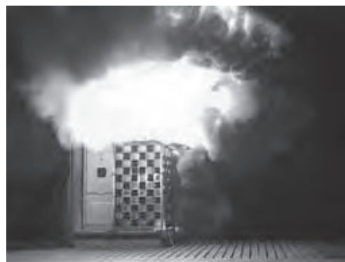
図1. 内部アーク安全性試験の様子
