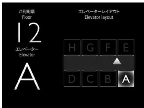
図1. 乗場操作盤登録時の液晶表示画面
