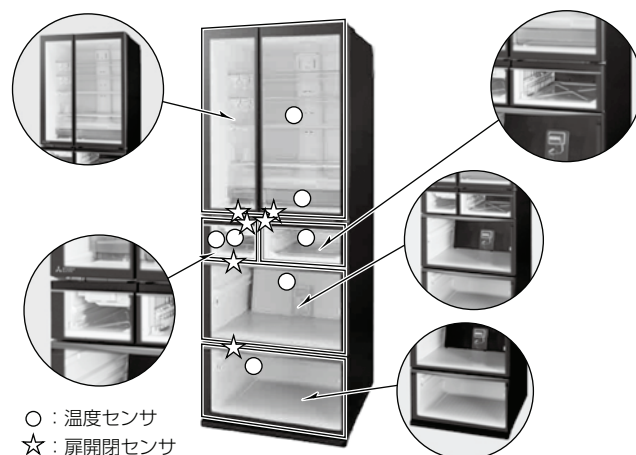
図2. 全室独立構造とセンサ位置
