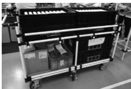
図4. 工場3日間改善で製作したキッキング台車
