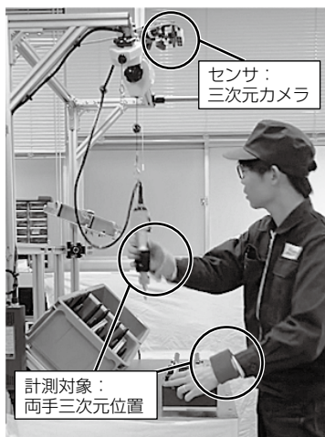
図2. 三次元カメラによるデータ計測
