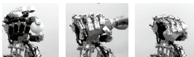
(a) セルフロック機構搭載ハンドの安定した把持
