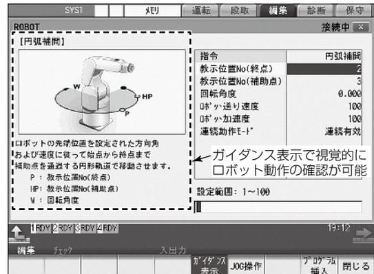
図5. ロボットプログラム作成画面のガイダンス表示
